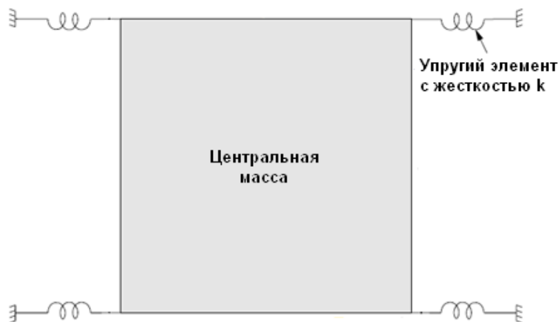
Рисунок 2 – Жесткая прямоугольная пластина, подвешенная на четырех упругих элементах (пружинах), расположенных по краям пластины
