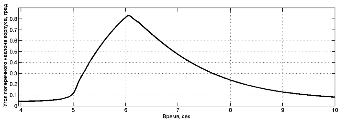
Рис. 3. Переходный процесс бокового крена корпуса МКМ при движении в повороте (управляемая подвеска)
