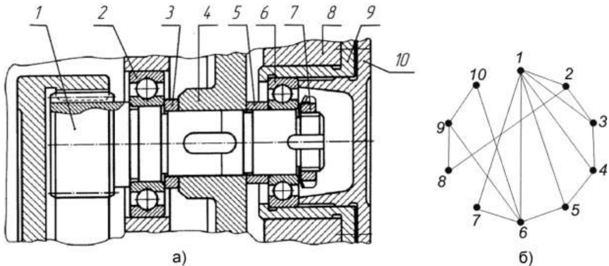
Рис. 1. Промежуточный вал цилиндрического редуктора (а), граф связей конструкции (б)
