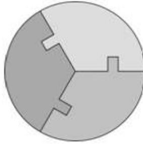
**Рис 3.** Пример конструкции, которая не может быть собрана при помощи секвенциальной операции
