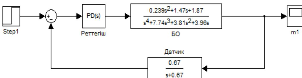
Рис. 5. Структура САУ с ПД-регулятором
