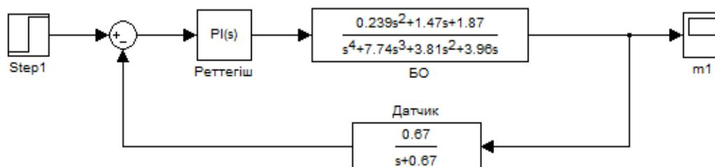
Рис. 1. Структура САУ с ПИ-регулятором
