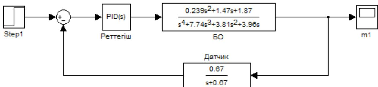
Рис. 9. Структура САУ с ПИД-регулятором
