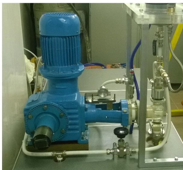
Рис. 3. Насос однопоршневой
