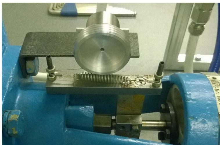
Рис. 6. Датчик перемещения штока насоса
