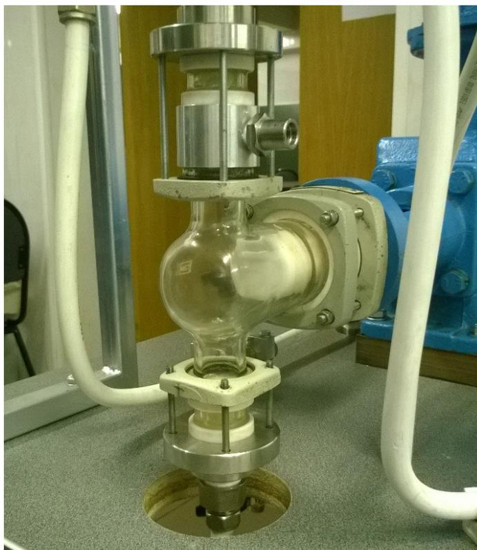
Рис. 5. Рабочая камера насоса
