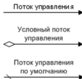
Рис. 6. УГО потоков управления
