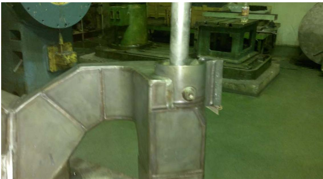
Рисунок 15. Обработка отверстий МДО в корпусах
