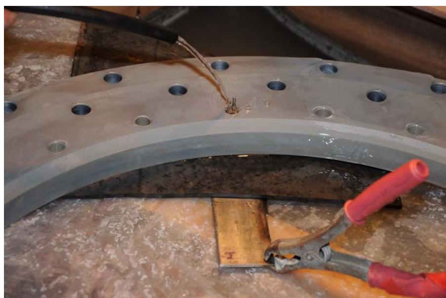
Рисунок 12. Обработка резьбовых отверстий
