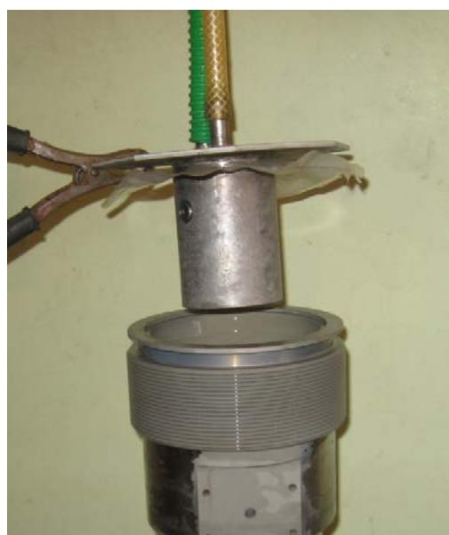
Рисунок 10. Обработка МДО отверстий
