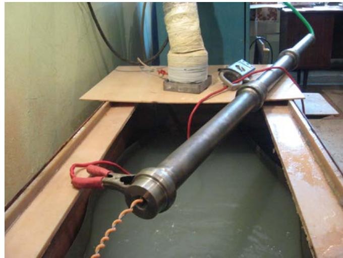
Рисунок 17. Оксидирование поверхности отверстия трубы
