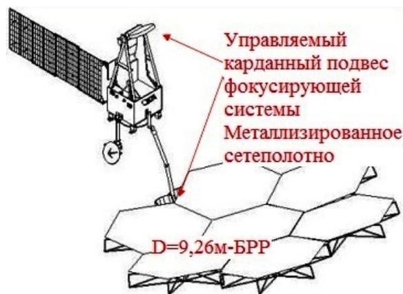
Рисунок 4.2 - Общий вид японского космического радиотелескопа международного проекта “ASTRO-G” (VISOP) с большим развертываемым рефлектором (год запуска - 2013)
