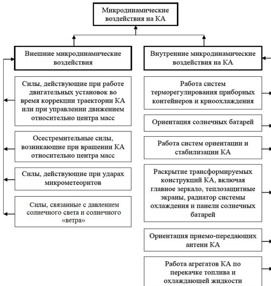
Рисунок 4.1 - Классификация микродинамических воздействий на КА с орбитой вокруг антисолнечной точки Лагранжа 2
