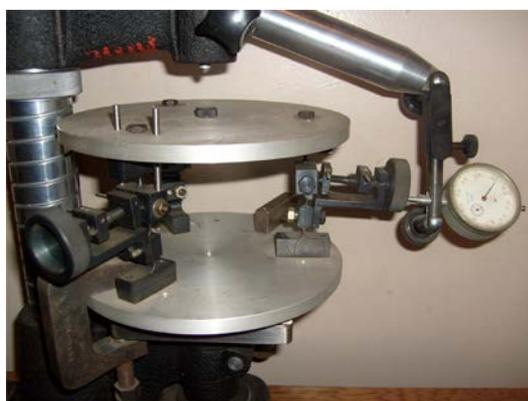
Рисунок 3.3 – Механизм параллельной структуры для сверхточного манипулирования в вакууме
