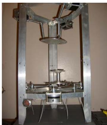
Рисунок 3.4 – Механизм параллельной структуры для технологических и измерительных систем
