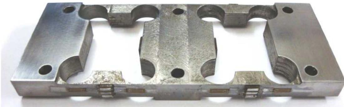
Рисунок 11 - Фотография упругого элемента тензометрических весов
