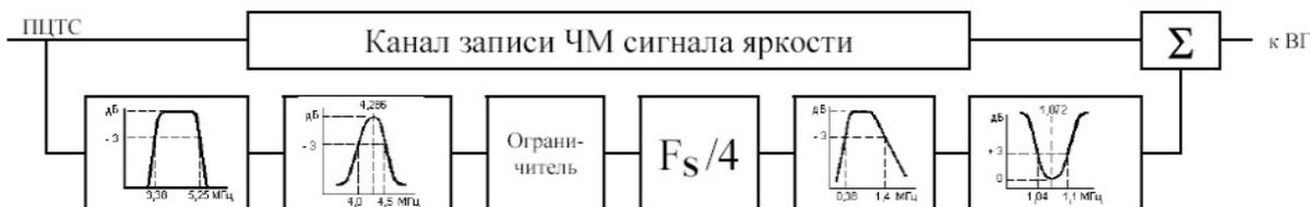
Рис. 4. Структурная схема канала записи видеосигналов SECAM
