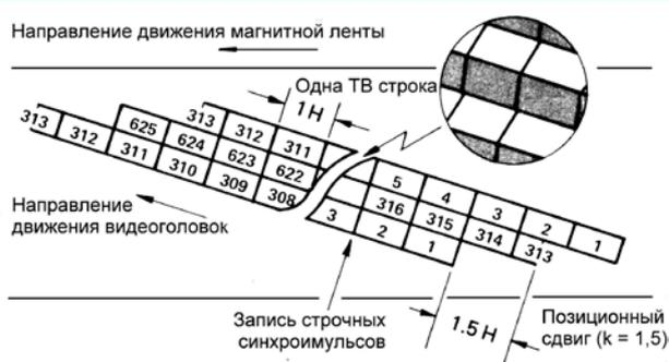
**Рис. 1. Формат записи сигналов ТВ (50 Гц/625 строк)**
