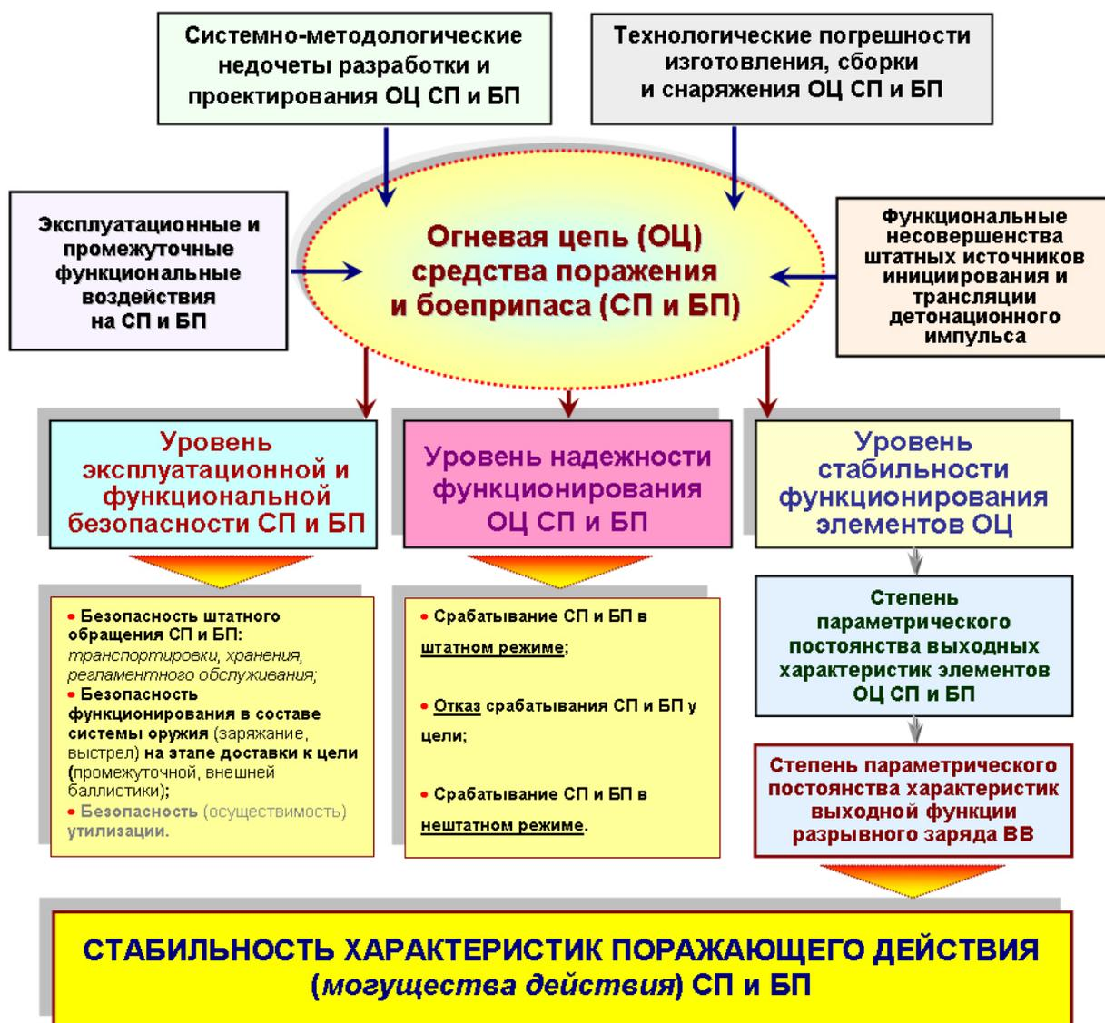
Рис. 3. Категории факторов, снижающих эксплуатационную безопасность, функциональную надежность и стабильность ОЦ СП и БП
