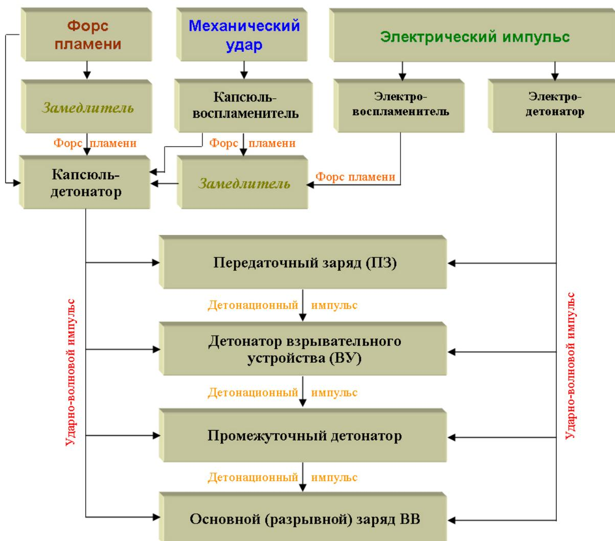
Рис. 1. Обобщенная структурно-функциональная схема ОЦ СП и БП
