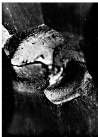
Рис. 4. Износ перемычки сверла
