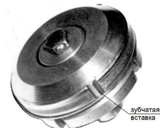
**Рис. 5.** Общий вид накатного ролика с вставными зубчатыми элементами
