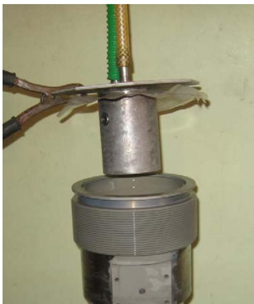
Рисунок 10. Обработка МДО отверстий
