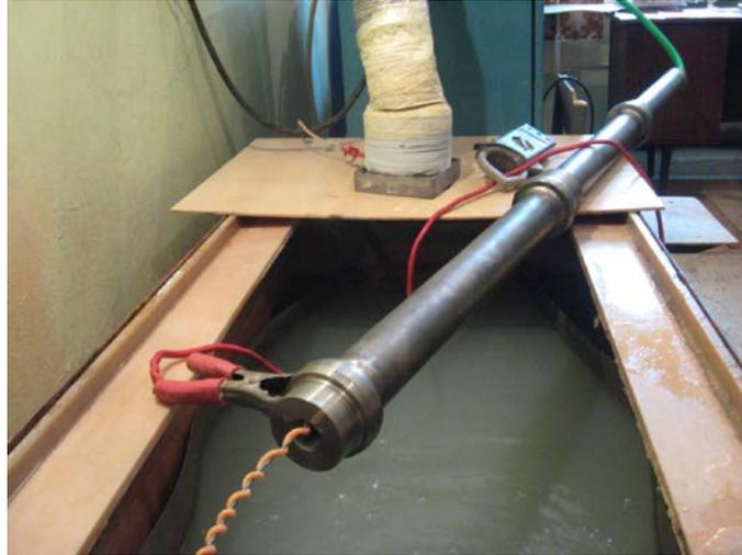
Рисунок 17. Оксидирование поверхности отверстия трубы
