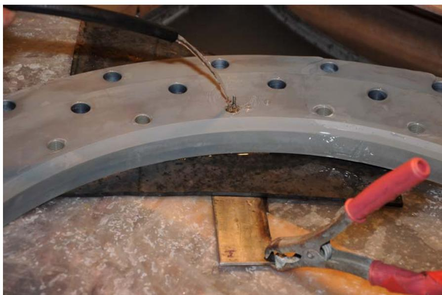
Рисунок 12. Обработка резьбовых отверстий
