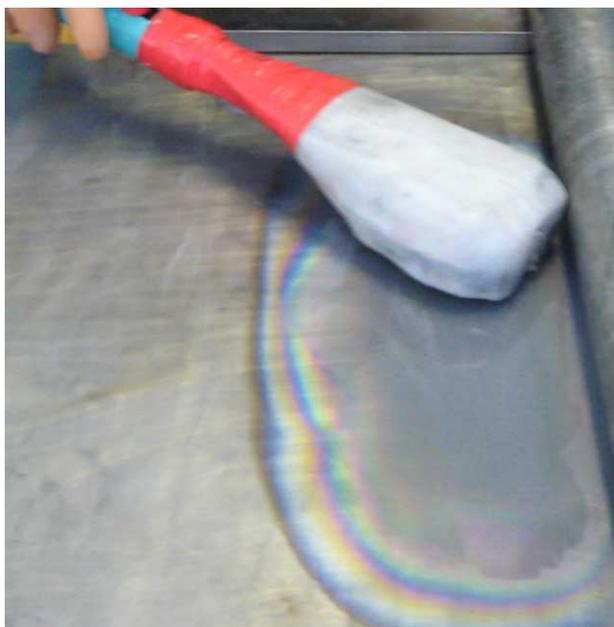
Рисунок 2. МДО плоским электродом горизонтальных, вертикальных и наклонных поверхностей
